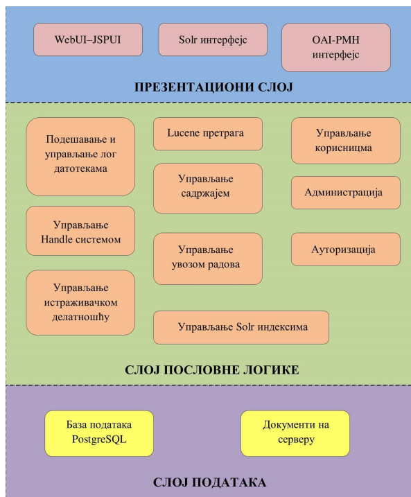
Слика 1. Трослојна архитектура платформе DSpace-CRIS
