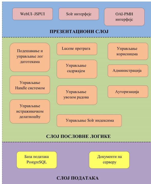
Слика 1. Трослојна архитектура платформе DSpace-CRIS
